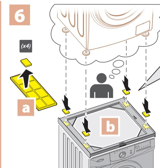
IT Se i piedini dell'asciugatrice non appoggiano correttamente su "Torre Up" rimuoverli; applicate i rettangoli adesivi nella posizione più idonea e verificate che l'asciugatrice si appoggi stabilmente.
